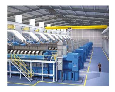
電力がインポートまたはエクスポートされる場合、 商用電源が停止した場合にグリッドから突然切り離 されると、マイクログリッドの電力バランスが崩れ ますが、Bergen enginesの電力バランスが整うまで、 IPCSのフライホイール式運動エネルギー貯蔵装置 によって補償されます。
